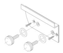
Altre possibilità di fissaggio sono date dai tappi lampada cod. 117.1803 e 117.1804 e dai tappi di sostegno 117.1802 e 117.1801. Questi tappi possono venir utilizzati per fissare la plafoniera a delle spalle di vetro, quando ci sia la necessità mascherare l'estremità del profilo stesso. Inoltre, i tappi di sostegno 117.1802 e 117.1801 sono sagomati in modo tale da contenere l'eventuale banchina rendi-resto.
